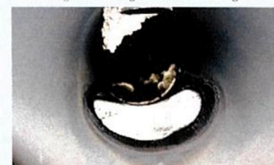
AdBlue® indsprøjtet. Materialeaflejring ved indsprøjtningens punkt.
