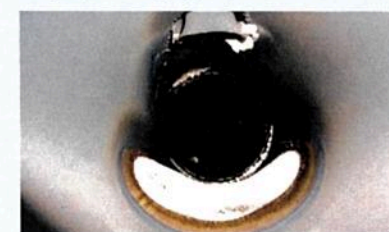
Air1 OptiSpray indsprøjtet. Næsten ingen materialedannelse ved rørbøjning, SCR-indløb.
